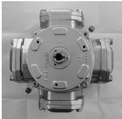
Рисунок В.1 Пломбировка генератора импульсов
