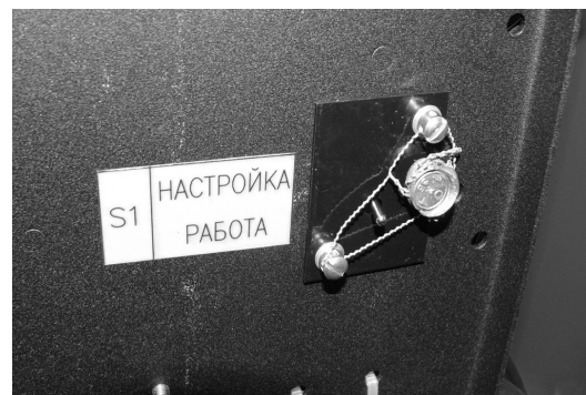
Рисунок В.3 Пломбировка блока управления
